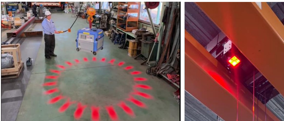
図1. クレーン作業安全支援システム：実証実験の様子
